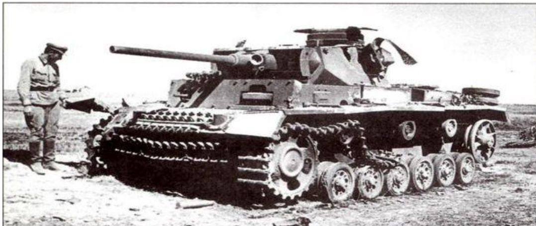
Подбитый немецкий танк. Запасные гусеницы передней части танка подвешены для усиления лобовой брони.
